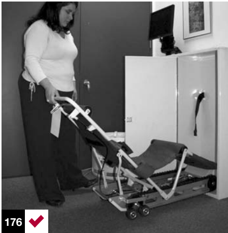
Foto 176: la forma más segura de evacuar personas con movilidad reducida por escaleras es con una silla de evacuación. Oficina ILRU. Houston, EE.UU.
