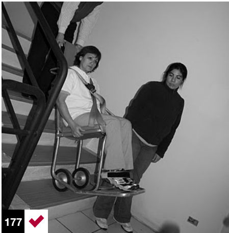
Foto 177: existen diferentes modelos de sillas de evacuación. Este tipo necesita 2 personas que asistan durante el descenso.
